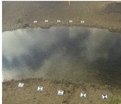
Figura 9. Distorsión de barril no corregida que crea curvatura en lo que en realidad son líneas rectas. Por lo general, ocurre en lentes de gran angular (Fuente: Sophie Pearce, Universidad de Newcastle, Reino Unido).
