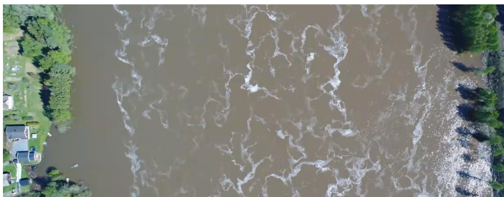
Figura 8. Imagen de un video de una crecida captado por un dron en Noruega. Las partículas trazadoras transportadas por el flujo son claramente visibles en la mayor parte del ancho del canal. Este video es muy bueno para el análisis de velocimetría de imágenes. Fuente: Kristoffer Florag-Dybvik, Dirección de Recursos Hídricos y Energía de Noruega (NVE).
