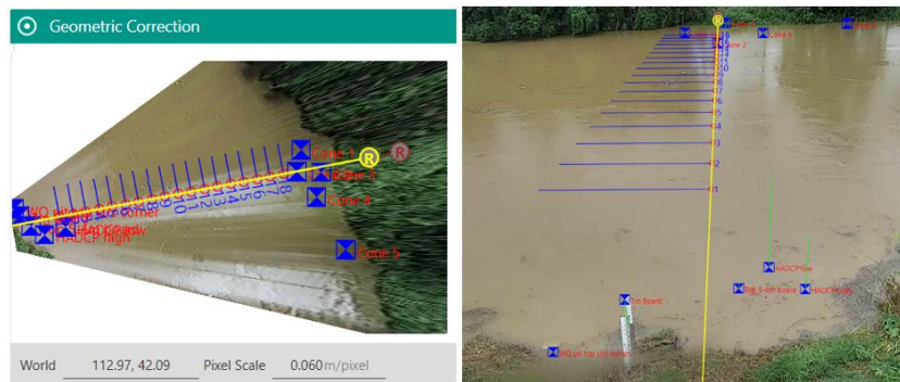
Figura 11. Una imagen ortorrectificada (izquierda) basada en las coordenadas del mundo real de cada punto de control terrestre y la imagen original de la cámara (derecha). Fuente: Mark Randall, RDMW, utilizando el software HydroSTIV.
