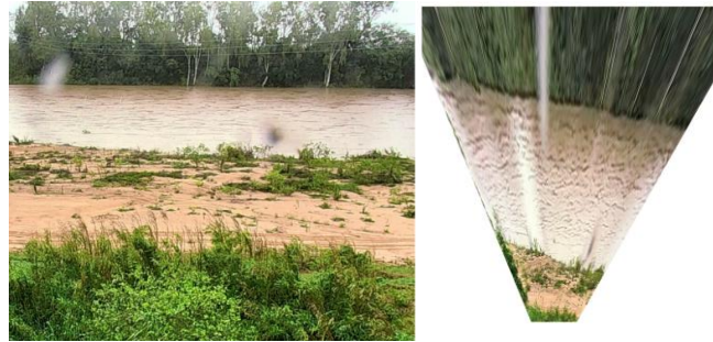
Figura 17. Imagen oblicua de la cámara (izquierda) y la imagen rectificada ajustada para aumentar el tamaño del fondo de píxeles a medida que aumenta la distancia desde la cámara. Fuente: Mark Randall, RDMW, utilizando el software HydroSTIV.
