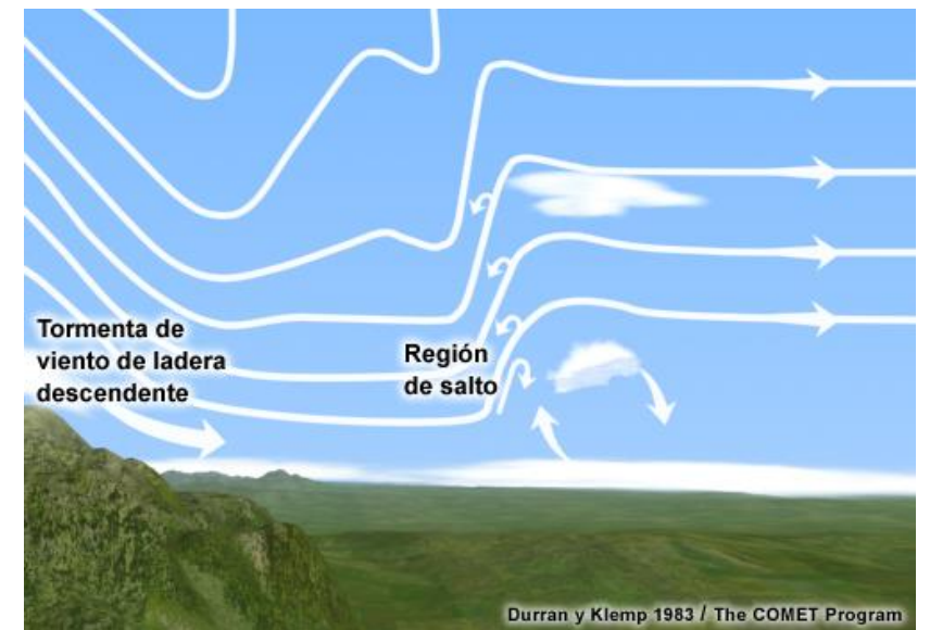
Dibujo esquemático de la formación de nubes de rotación a sotavento, fenómeno que ocurre cuando las ondas presentan una gran amplitud y la energía se propaga a niveles bajos.
