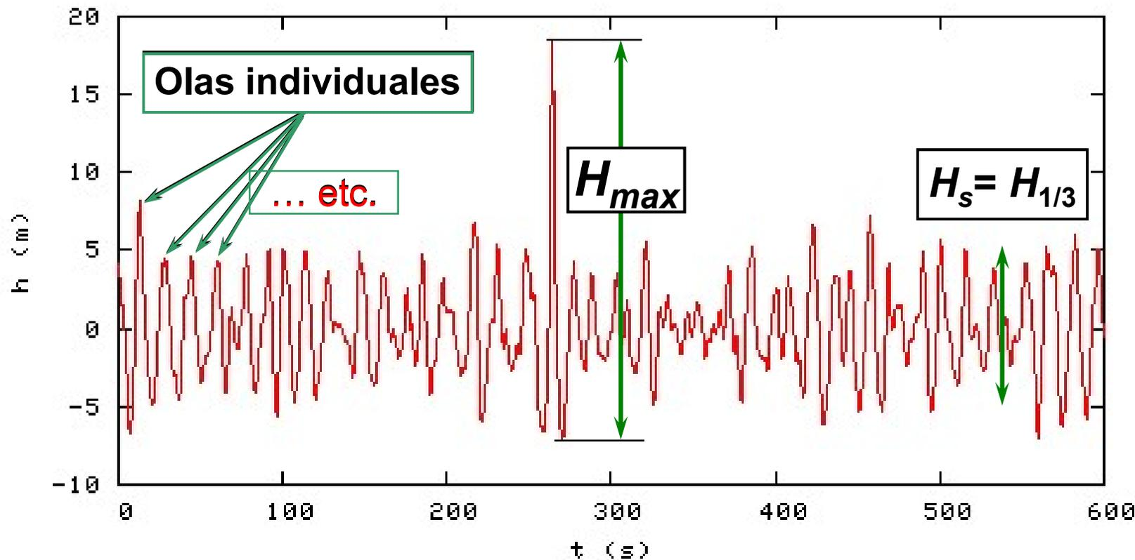
Si  $H_{max} > 2.2H_s \rightarrow$  suceso de "freak wave"
