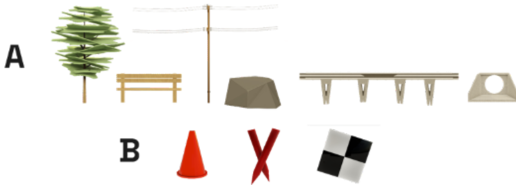
Figura 30: Ejemplos de elementos que pueden utilizarse como CPs. A) Elementos que pueden encontrarse en el sitio. B) Ejemplos de elementos temporarios. Fuente: Elaboración propia
