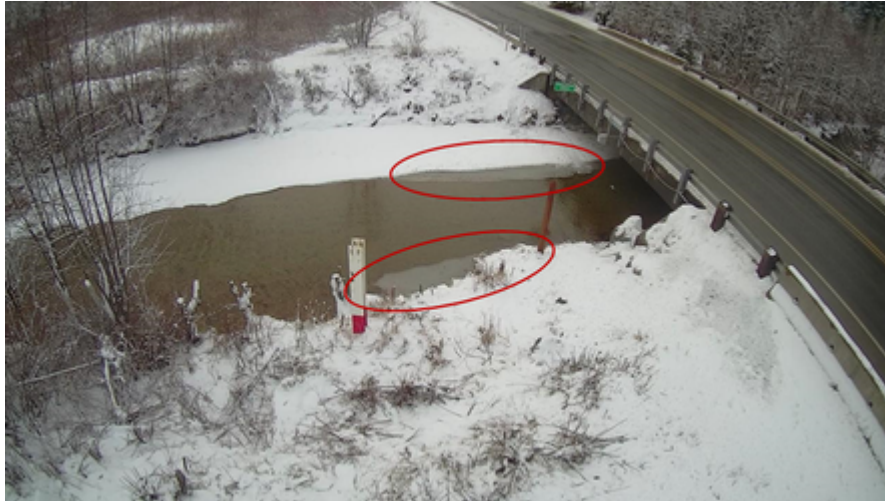
Figura A.4.17: Placas de hielo estáticas sobre la superficie del flujo. Fuente: Imagen proporcionada por National Hydrological Service of Environment and Climate Change Canada
