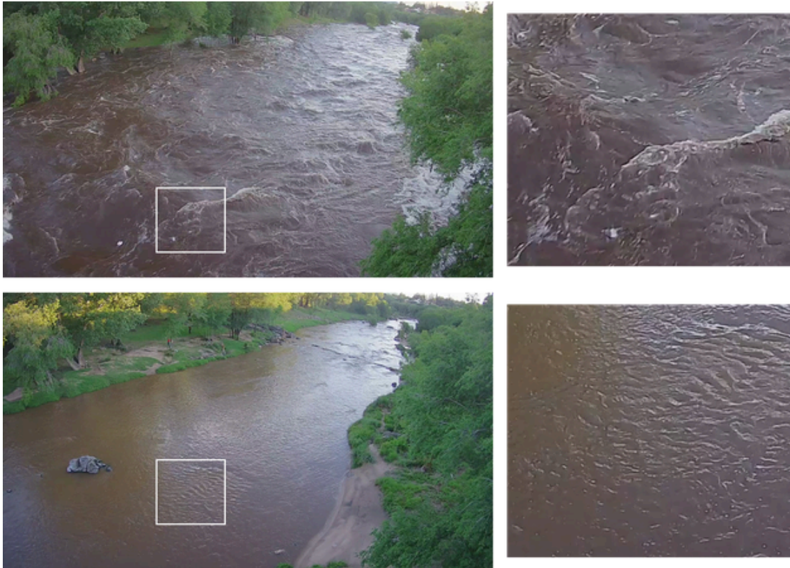
Figura A.4.1: Ejemplos de presencia de trazadores superficiales naturales generados por estructuras turbulentas. Fuente: Elaboración propia
