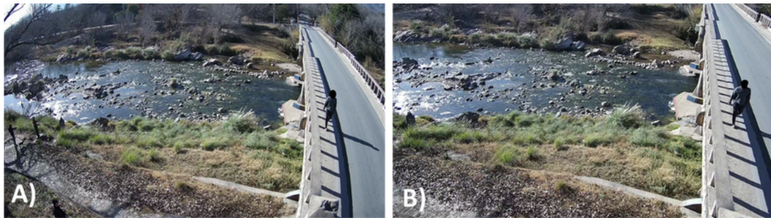
Figura A.1.9: Ejemplo de corrección de la distorsión debido a la lente. A) Foto original; B) Foto con corrección de distorsión por lente. Fuente: Elaboración propia
