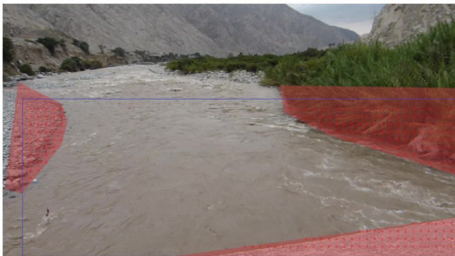
Figura 47: Definición de la Región de Interés (ROI) y máscaras. La ROI está representada por el rectángulo azul, mientras que las áreas enmascaradas se muestran en rojo. Fuente: Elaboración propia
