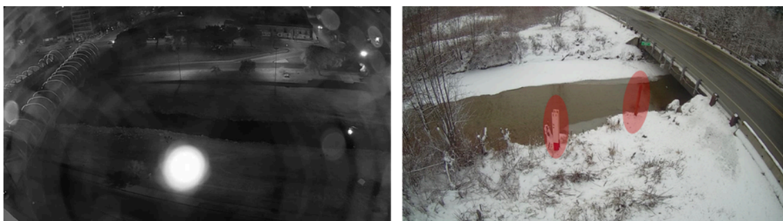
Figura A.4.11: Elementos que obstruyen la visual del área de medición del flujo. Izq.: Insecto sobre el lente de la cámara. Der.: Elementos que pertenecen al sitio y obstruyen parcialmente el flujo. Fuente: Elaboración propia. Algunas imágenes fueron proporcionadas por National Hydrological Service of Environment and Climate Change Canada
