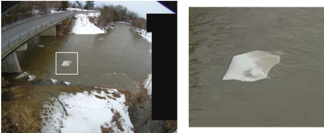
Figura A.4.4: Ejemplo de placas de hielo en superficie como trazador superficial natural. Fuente: Imágenes proporcionadas por National Hydrological Service of Environment and Climate Change Canada
