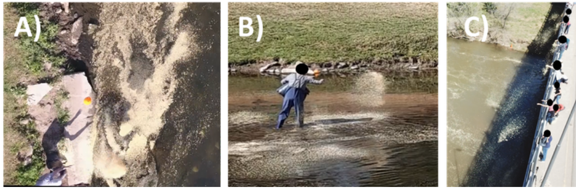
Figura A.4.8: Ejemplos de formas de sembrado. A) Desde las márgenes del cauce. B) Desde dentro del cauce. C) Desde una estructura (puente) que cruza el cauce.
