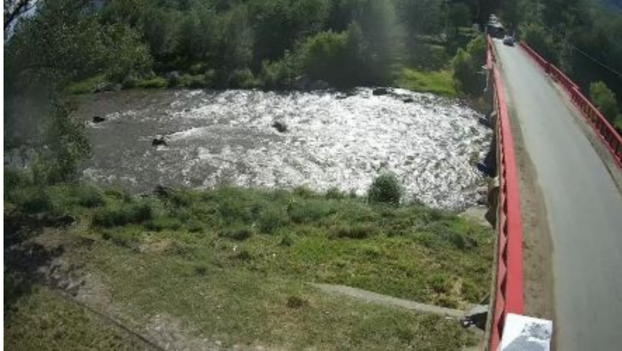
Figura A.4.13: Presencia de reflexiones solares indeseadas sobre el área de interés del flujo. Fuente: Elaboración propia
