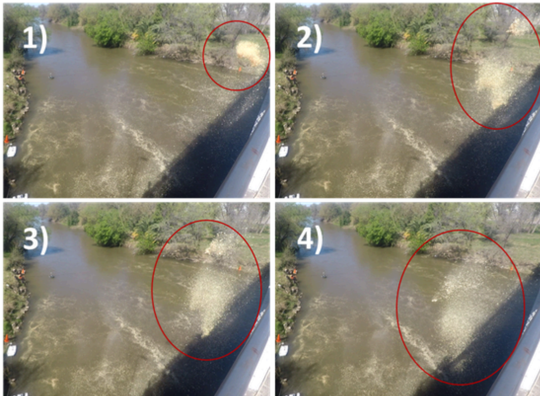
Figura A.4.9: Ejemplo de obstrucción de la visual del flujo durante el proceso de sembrado. Fuente: Elaboración propia
