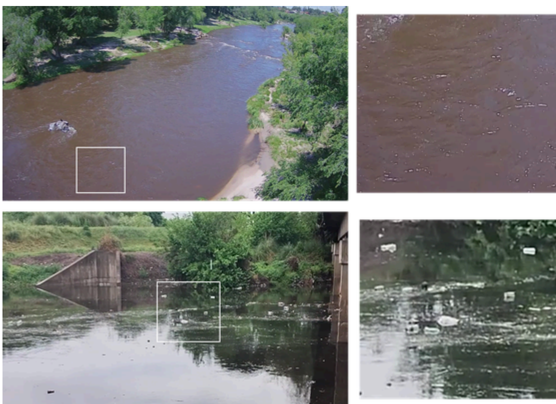
Figura A.4.3: Ejemplo de restos de vegetación y residuos urbanos flotantes como trazador superficial natural. Fuente: Elaboración propia
