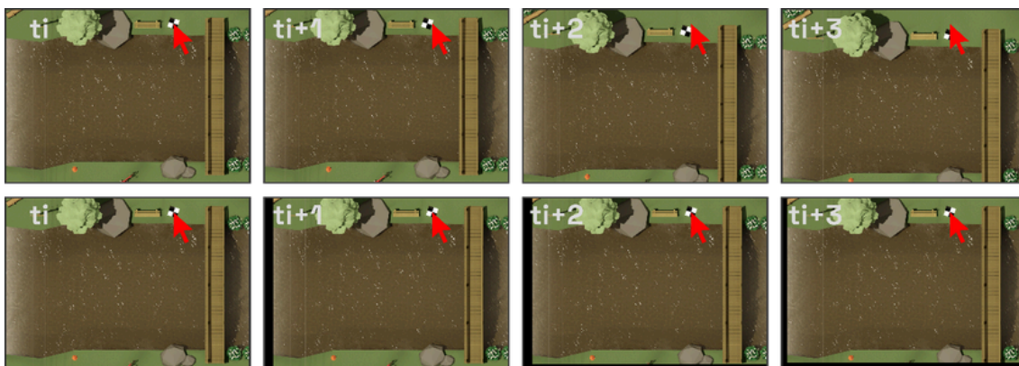
Figura 41: Corrección de movimiento de cámara en secuencia de imágenes extraídas de un video. Arriba: Secuencia de imágenes con movimiento de cámara.
